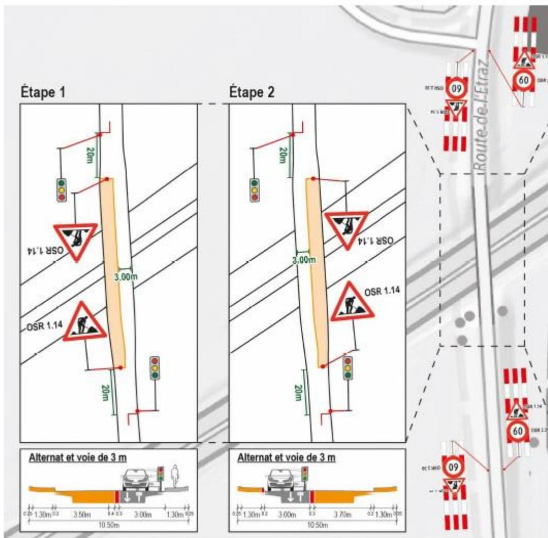
Figure 5 – PS Etraz - Gestion du trafic sur ouvrage
