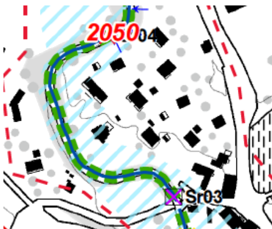
Figure 1 : Point de débordement (Sr03 – croix violette) de la Serine sous la route du Petit Pont
